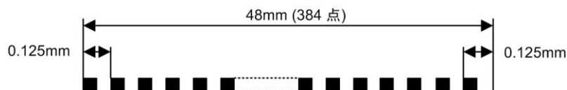
图 2.1 加热单元尺寸
