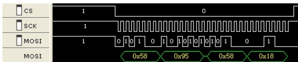
图 6.1 写命令函数使用示例时序图
