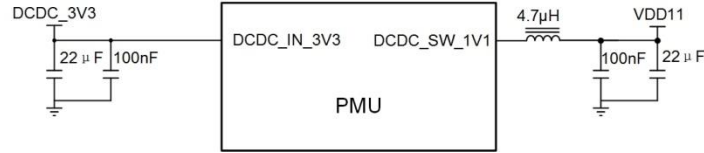
图 4.2 PMU 参考电路
