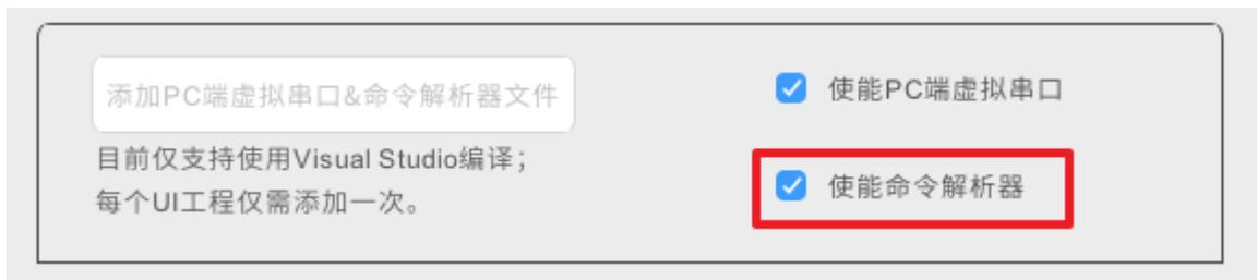
该命令解析器仅能解析固定长度的串口指令，指令长度PARSE\_CMD\_LEN可在cmd\_parsing\_example中修改。
