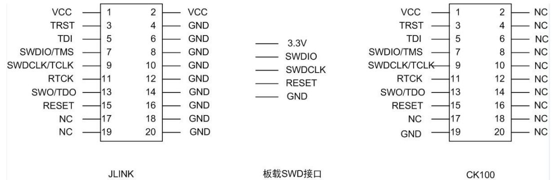
图 4.1 仿真器与板载调试口连接关系图
