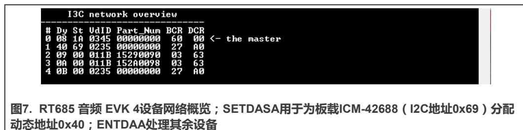
该I3C网络概览的位置0始终显示I3C主设备的参数（动态地址0x08，静态/I2C地址0x1A，供应商ID 0x0345——为本演示随机选择，型号0x0，BCR/DCR为0x60/0x00）。I3C主设备参数总是由SDK的I3C驱动程序设置。对于列到位置1的从设备，其参数来自从设备本身，并通过I3C CCC的命令之一获取。静态地址00表示在DAA过程运行时，没有关于从设备I2C地址的信息。
