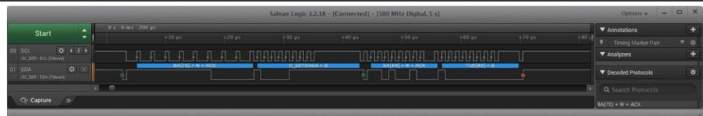
图24. RT685音频EVK板（仅SETDASA），SETDASA用于将动态地址0x40分配给I2C地址为0x69的从设备
