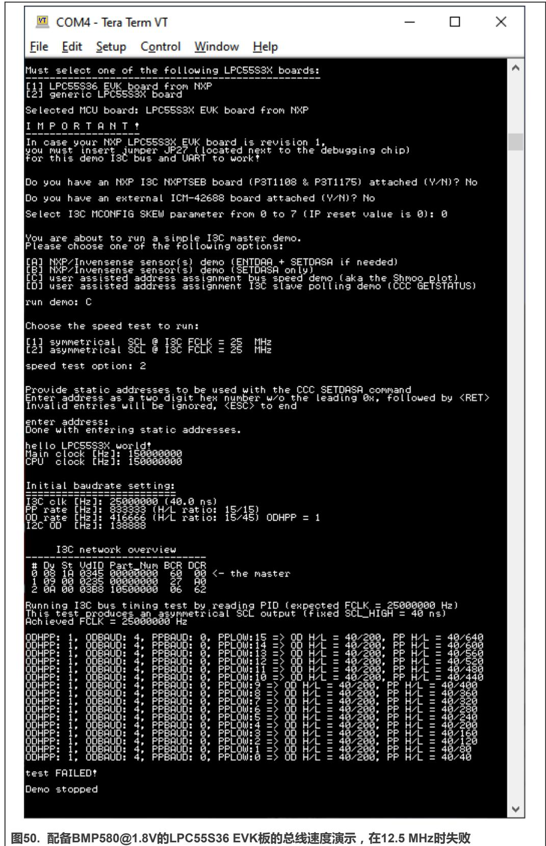
图50. 配备BMP580@1.8V的LPC55S36 EVK板的总线速度演示，在12.5 MHz时失败
