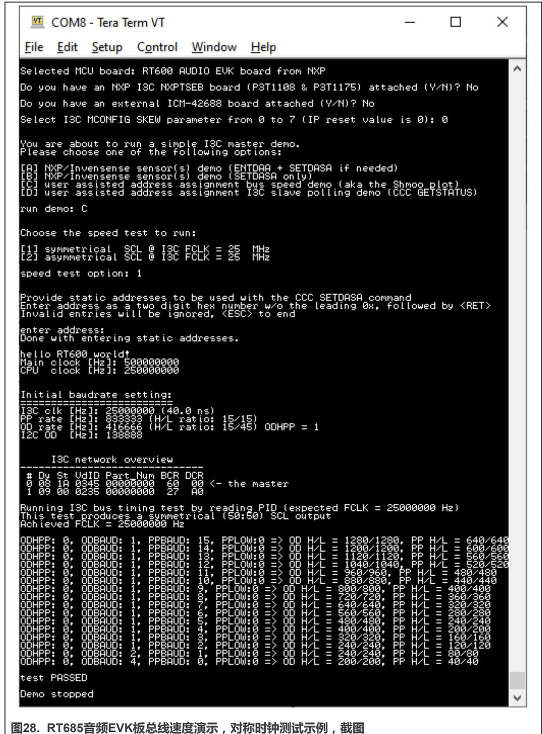
图28. RT685音频EVK板总线速度演示，对称时钟测试示例，截图
