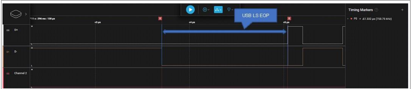
图15. USB LS主机的EOP时序
