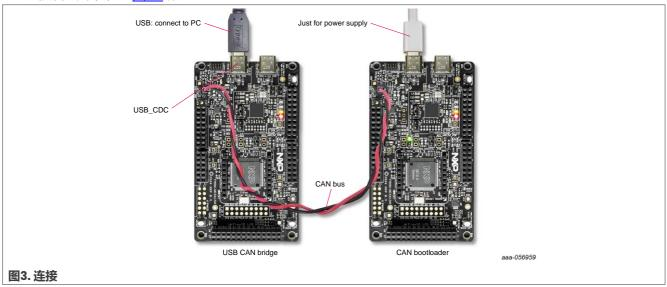
can bootloader 电路板的电源可以连接到任何能够提供 5V 电压的 PC 上。
