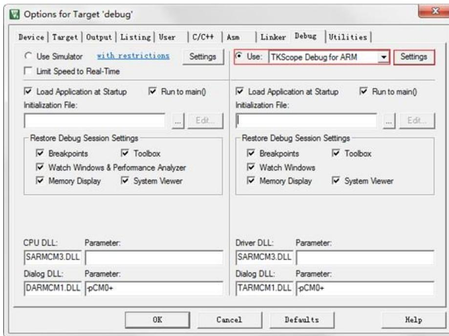
图 4.5 设置 TKScope Debug for ARM
