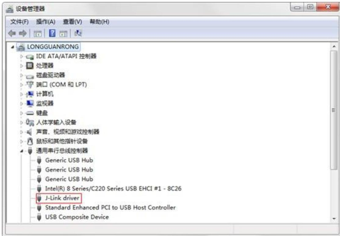
图 2.28 J-Link 仿真器驱动已正确安装
