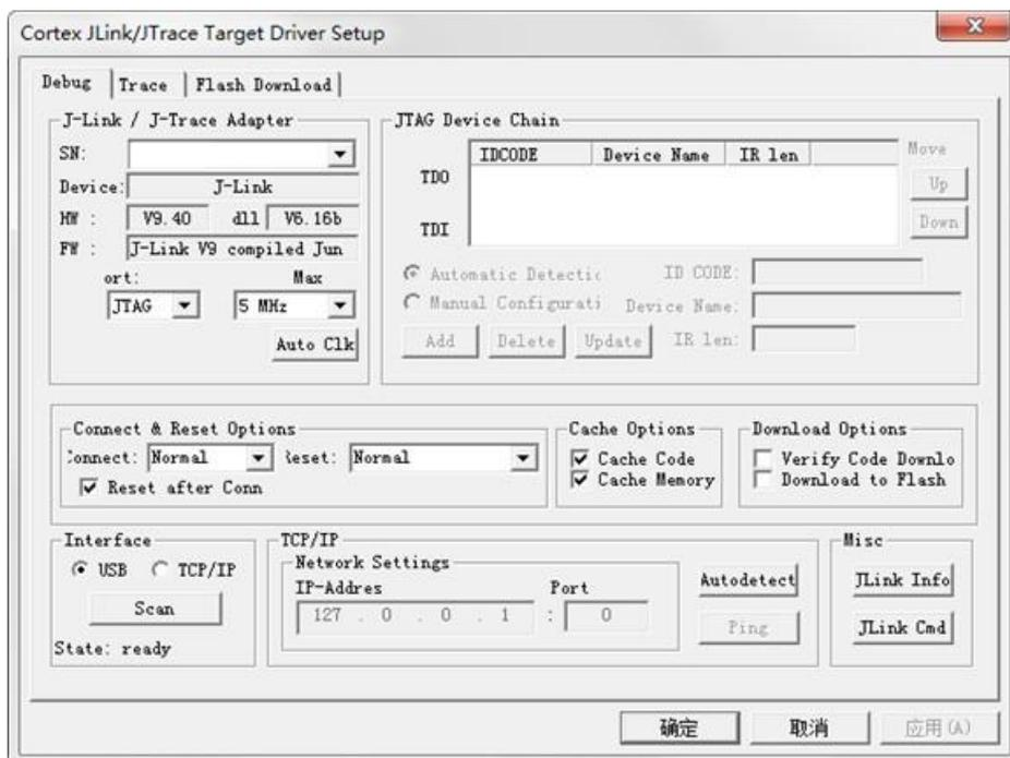
图 4.20 J-LINK Debug for ARM 配置选项
