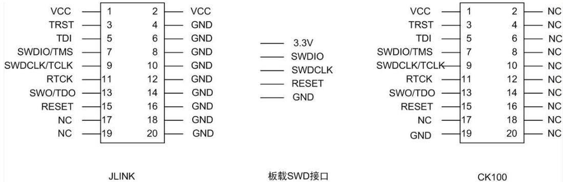
图 4.1 仿真器与板载调试口连接关系图
