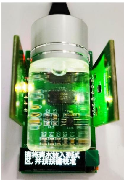
清水校准成功后，再进行浑水校准操作，将浑浊度为 100% 的清水放入 WQS100 的检测区即可。
