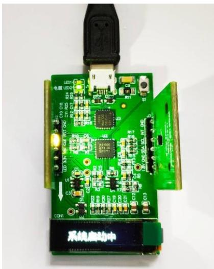
系统初始化成功后，首先进行清水校准操作，将浑浊度为 0% 的清水放入 WQS100 的检测区即可。
