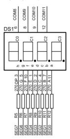
图 2.3 共阴数码管电路
