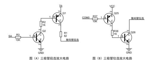
图 2.5 三极管放大电路
