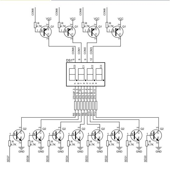
图 2.4 共阳数码管电路
