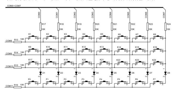
图 2.2 多个功能键复用按键电路
