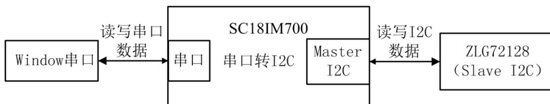
图 7.1 SC18IM700 通信流程图
